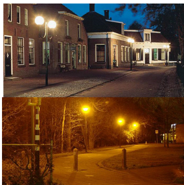
Foto 4.2: Wegbeeld met wit (boven) en geel (onder) licht. Met wit licht zijn kleuren te onderscheiden. Met geel licht kan dit niet.
