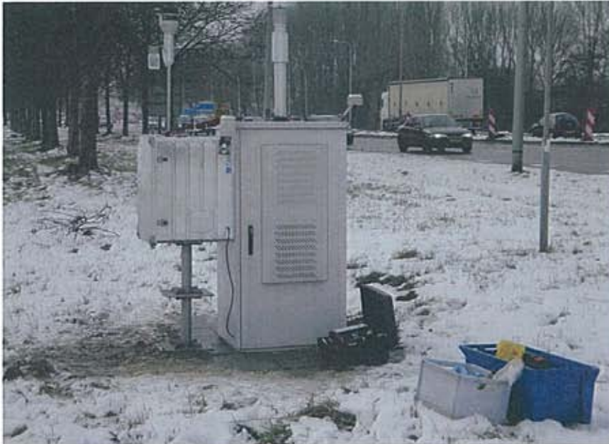
Figuur 3: Meetopstelling aan de Pleijroute. Links de MAAP-monitor, rechts de fijn stof meetbehuizing van de provincie Gelderland (foto: TNO).
